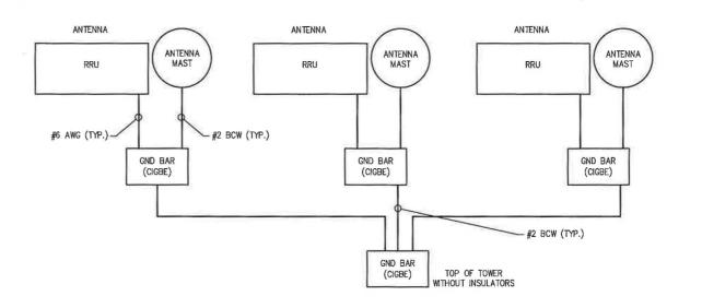
SCHEMATIC DIAGRAM GROUNDING SYSTEM
